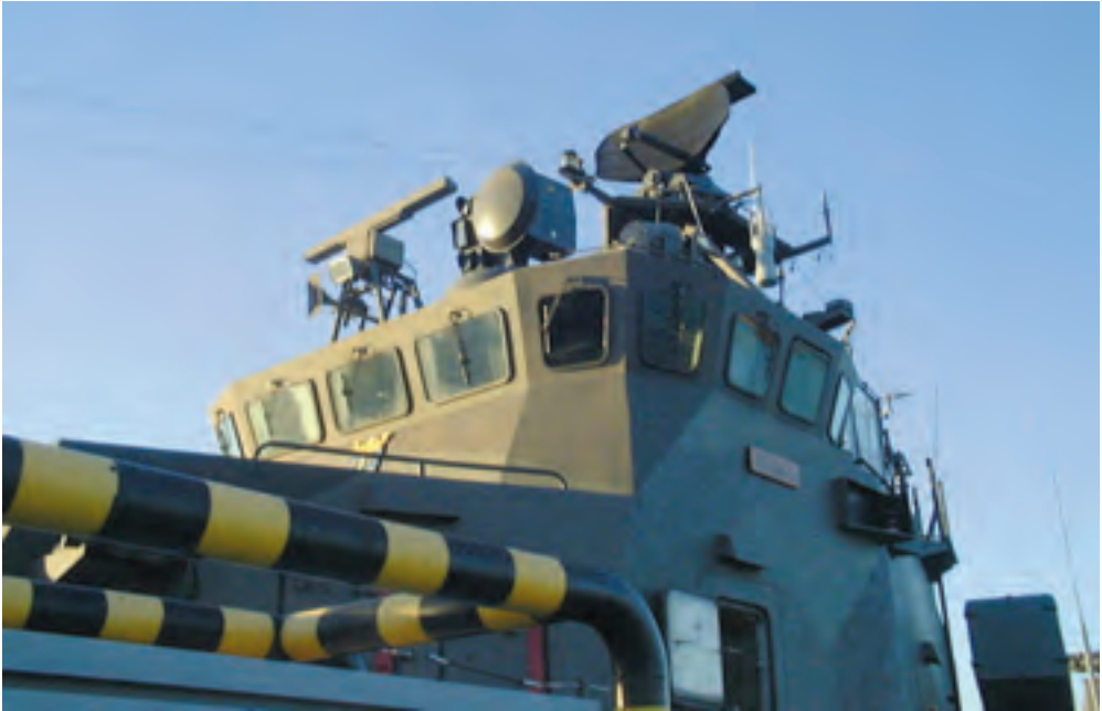
Rauma-luokan ohjusveneen tutka-antennit.
