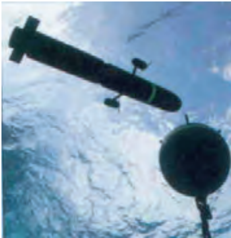
Kauko-ohjattava robotti vie räjähdyspanoksen miinaan.
